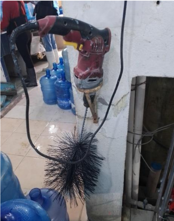
Figura 2. Taladro para limpieza interior de botellones.
